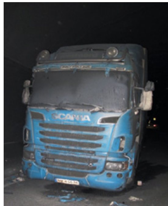
Slik så det ut etter brannen i mai i år. Den hvite lastebilen sto 130 meter bak traileren som brant, og den blå 200 meter bak. Varmen fra den brennende traileren antente den hvite og smeltet den blå.
