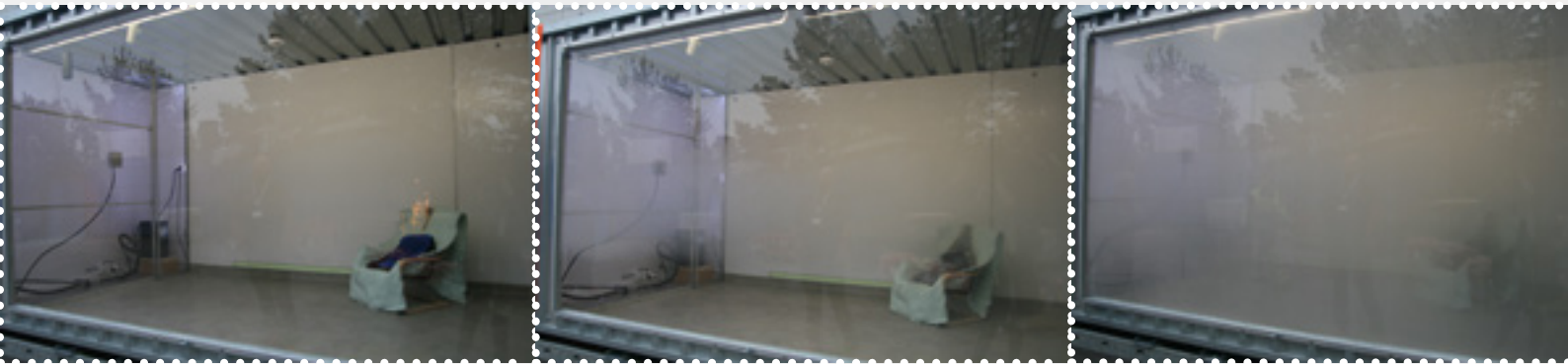
Branntilløpet lokaliseres raskt, og vanntåken slukker brannen raskt.
