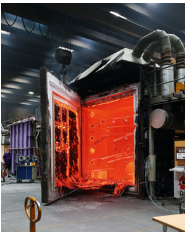
Foto: DBI Den side av vindusglasset som vendte inn mot ovnen er flytende etter testen. Den andre siden av glasset ikke er brent igjennom.
