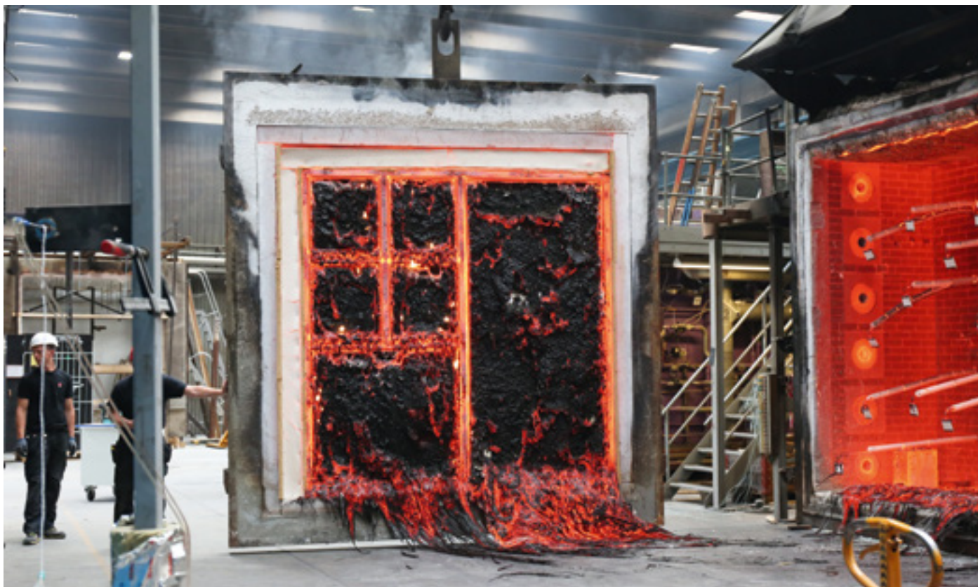
Foto: DBI Glasset i 3-fags-vinduet er flytende etter to timers branntest.
